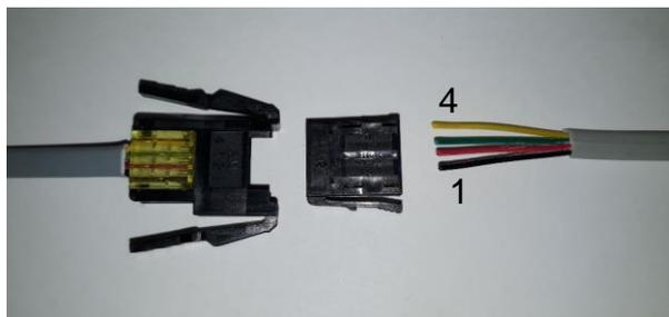
Подключение кабеля панели управления
