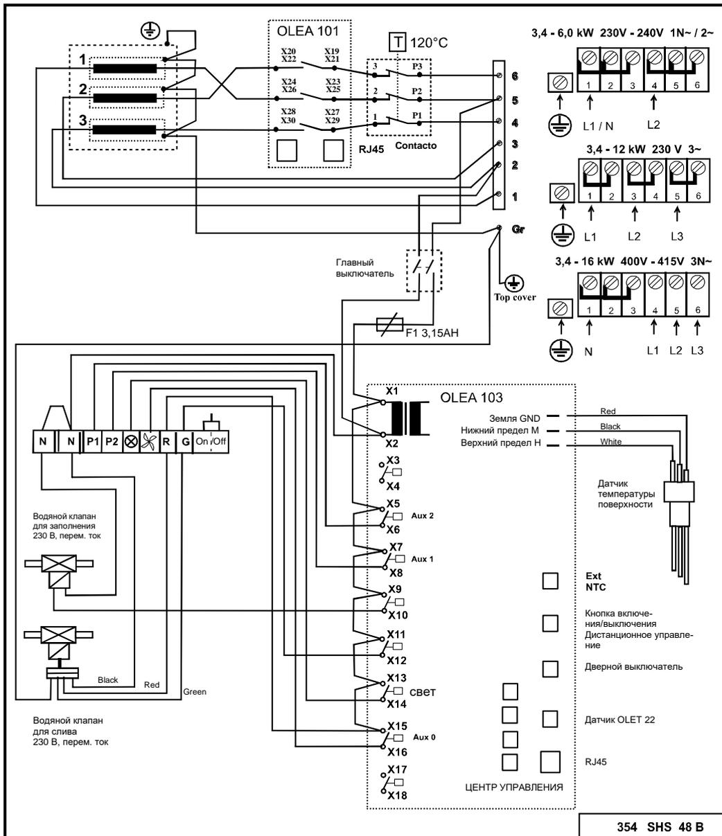
**ПРИМЕЧАНИЕ.** Управление освещением в парной через печатную плату возможно только для активной нагрузки (лампы накаливания). Реле платы не сможет выдерживать емкостные нагрузки (импульсные блоки питания). Если светильники в сауне оснащены трансформаторами (например, при использовании светодиодных или галогеновых ламп), релейный регулятор печатной платы парогенератора должен быть подключен к отдельному реле или контактору управления лампами.
