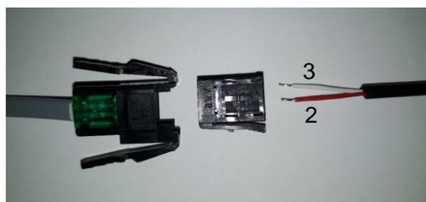
Подключение кабеля датчика температуры
