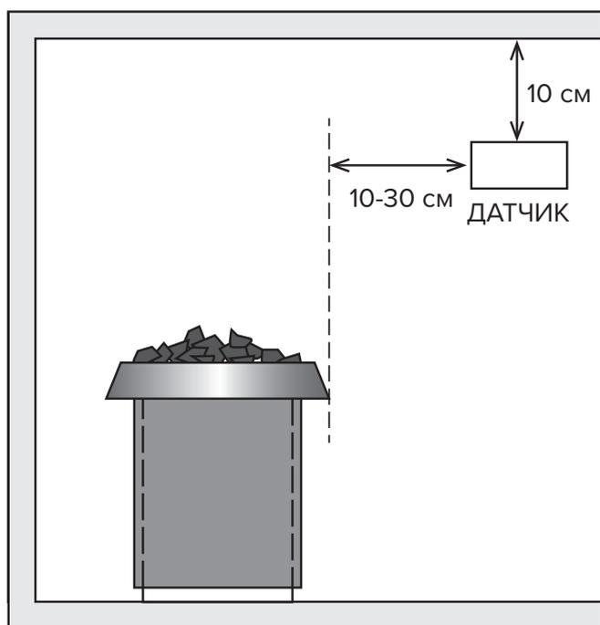
Датчик температуры можно установить на потолке в 10-30 см от внешнего края печи.
